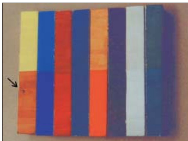
9. Próbkę z polichromią temperową po gazowaniu formaldehydem (oświetlenie dzienne), strzałka wskazuje miejsce wycieku żywicy przez powłoki farby.
