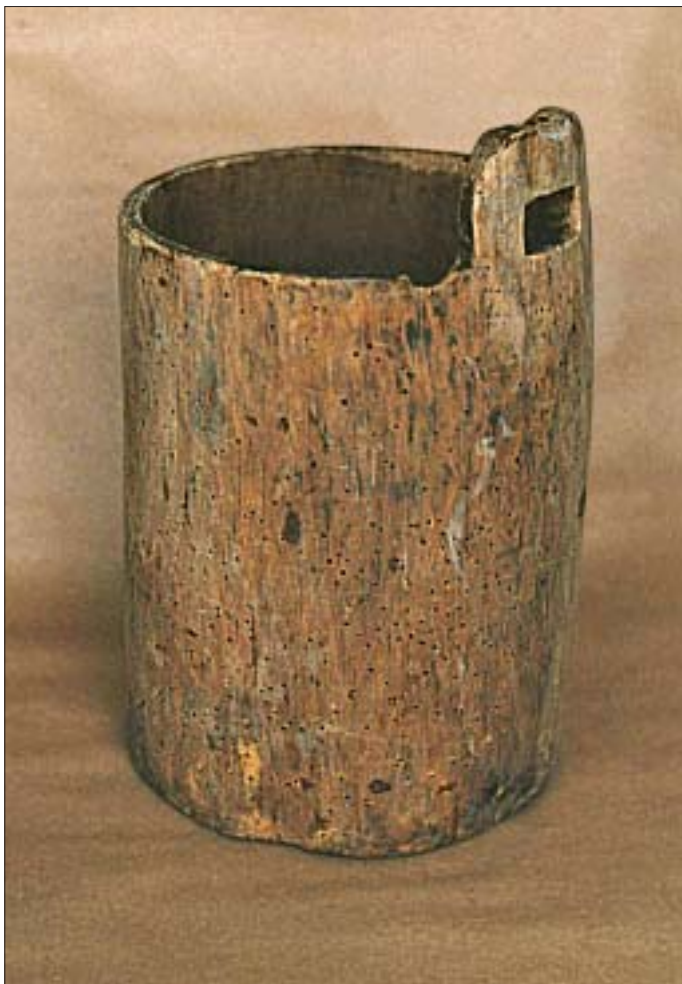
1. Przykład żerowisk kołatka domowego ( Anobium punctatum De Geer) w drewnianym naczyniu zasobowym. Wszystkie zdjęcia autorka.
