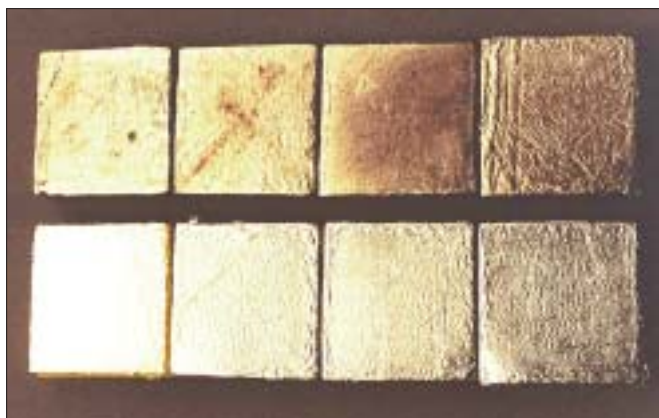
3. Wpływ oparów formaliny na imitacje pozłoty ze szlagmetal: górny rząd to próbki gazowane oparami formaliny, dolny rząd – próbki kontrolne.
