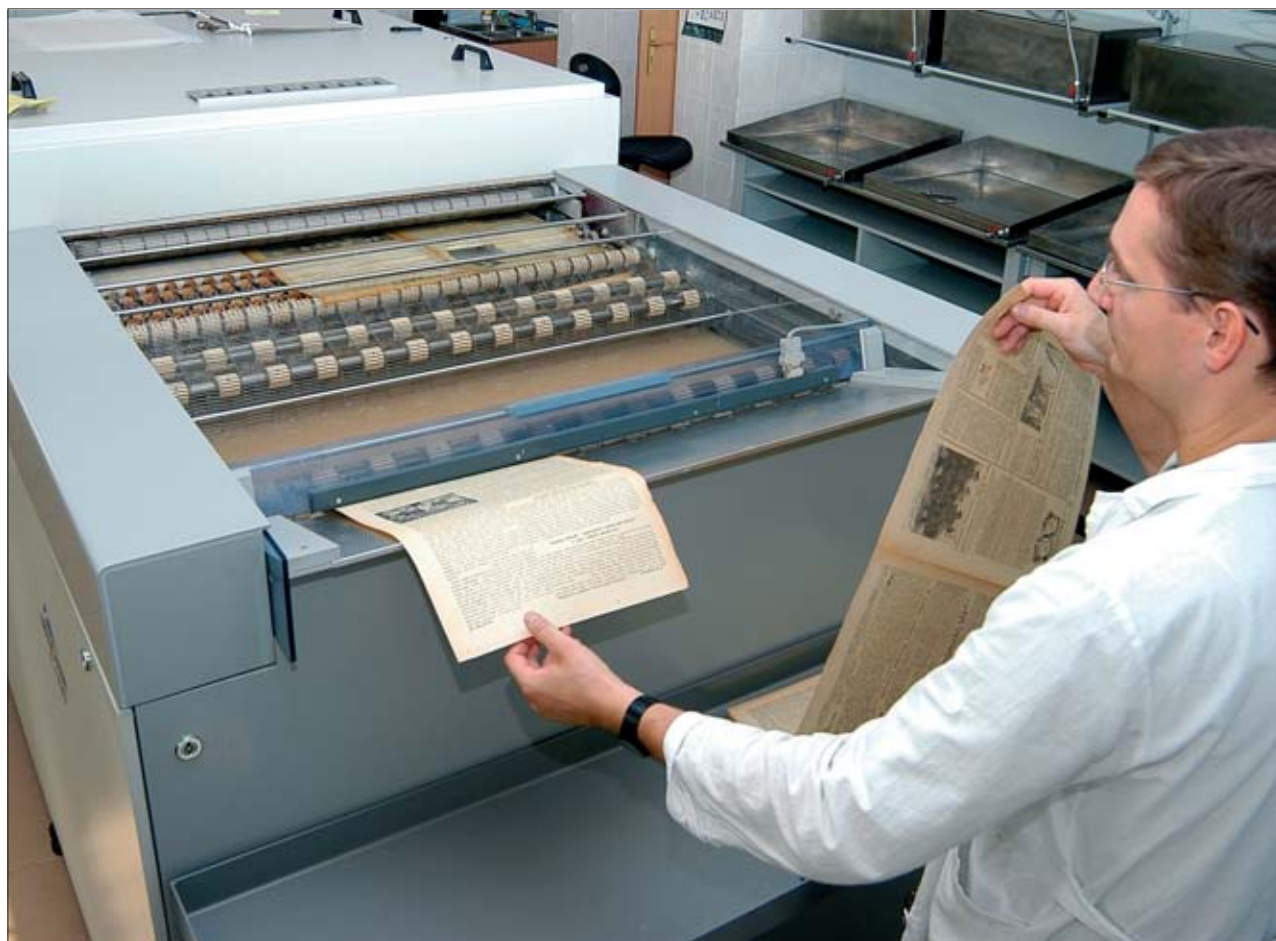
5. Odkwaszanie arkuszy w aparacie C 900 ( Neschen ). Fot. W. Sobucki. 5. Deacidification of sheets in a C 900 ( Neschen ) apparatus. Photo: W. Sobucki.
