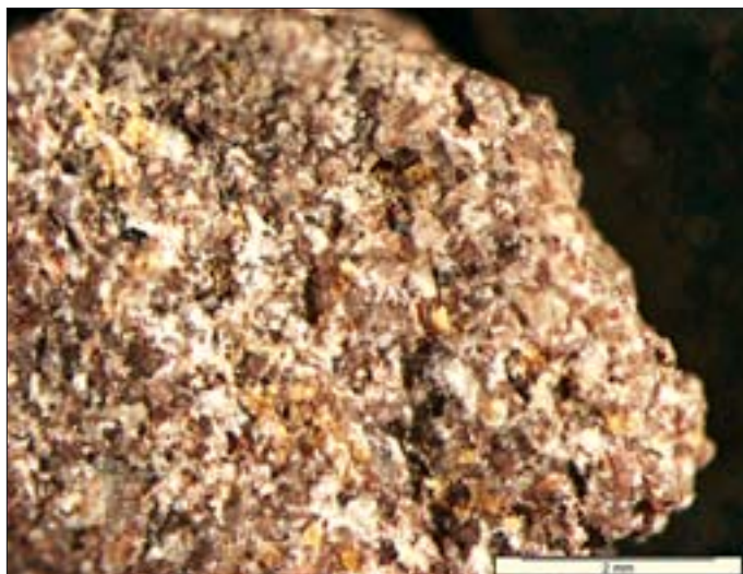
19. Obraz makroskopowy próbki głowicy kolumny (dep. 65). 19. Macroscopic image of a sample of a column capital (dep. 65).
