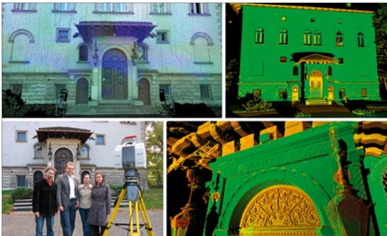
10. Testowy pomiar willi Richtera przy ul. Skorupki w Łodzi z zastosowaniem skanera 3D firmy Leica. Archiwum autorki. 10. Test measurement of the Richter villa in Skorupki Street in Łódź using of a Leica 3D scanner. Author's archive.
