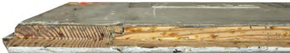
2. Oszlifowane czoło pionowej listwy drzwi przygotowane do pomiaru szerokości przyrostów rocznych. Fot. Zdzisław Nowakowski
