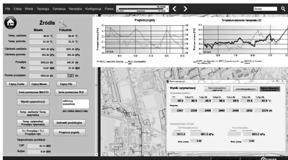
Rys. 5. Wyniki optymalizacji temperatury źródła z predykcją nastaw na podstawie prognozowanych danych pogodowych i zapotrzebowania na ciepło
