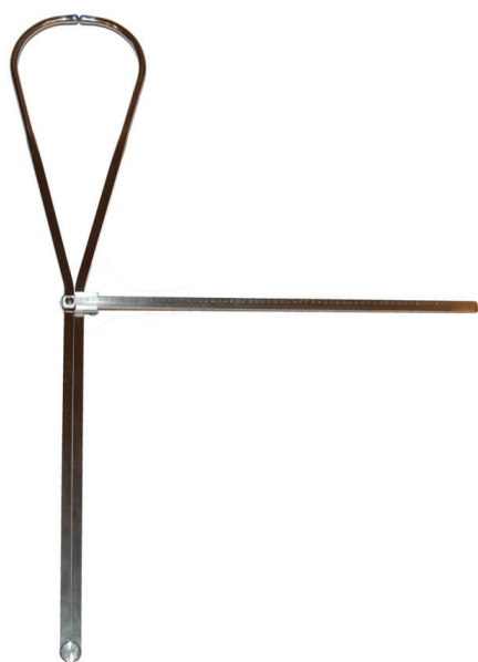
Ryc. 1. Cyrkiel kabłąkowy duży do pomiarów antropometrycznych.
