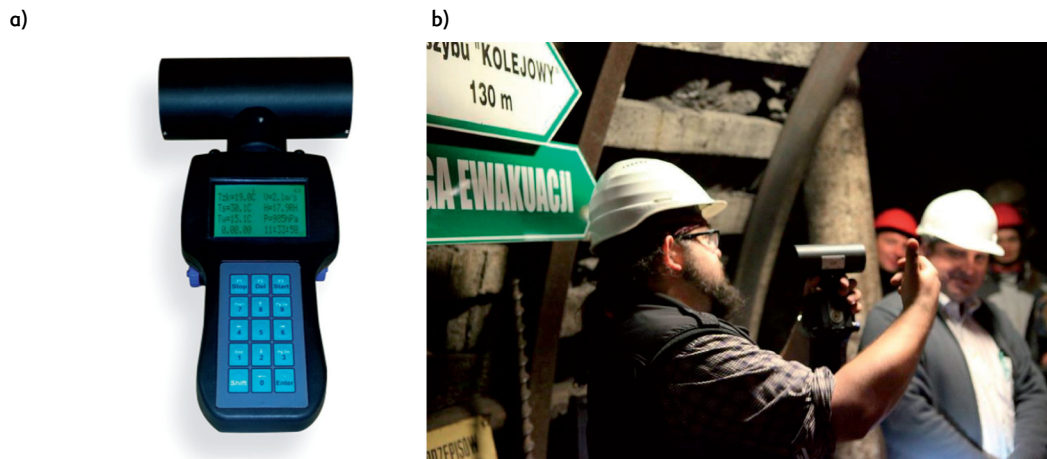
Rysunek 4. Aparatura na stanowisku do badania prędkości przepływu powietrza wykorzystująca fale ultradźwiękowe: a) anemometr ultradźwiękowy ATZK — wersja dydaktyczna — widok, b) anemometr ATZK na stanowisku badawczym nr 2
