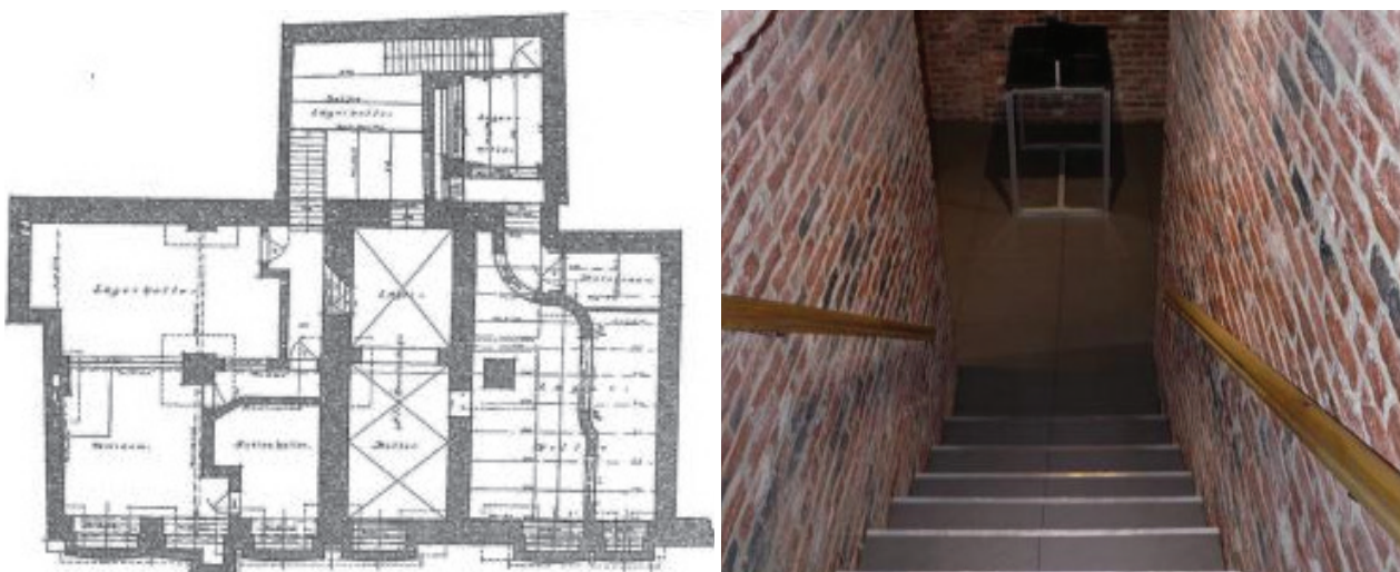
Il. 4. Rzut piwnic, projekt z 1906 r. (źródło: [13]) oraz współczesny wygląd średniowiecznych wątków ceglanych wyeksponowanych w piwnicy (fot. P. Kirschke, 2015)
