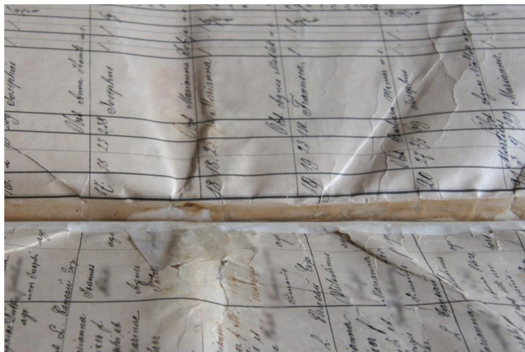
Fot. 10. Silne odkształcenie kart spowodowane skurczem klejów Źródło: Fot. K. Kwaśniewicz.
