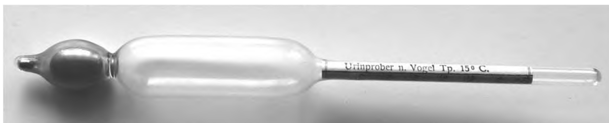
fot. 5 Miernik gęstości moczu, szkło, obciążnik rtęciowy, dł. 14 cm, średnica 16 mm, przed 1914.
