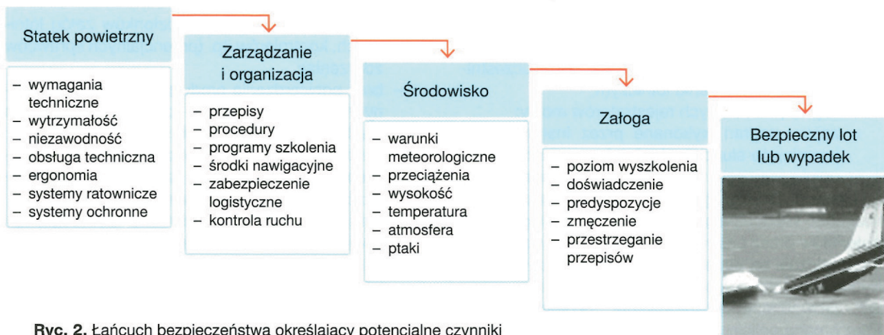
Ryc. 2. Łańcuch bezpieczeństwa określający potencjalne czynniki kształtujące poziom bezpieczeństwa i przyczyny ewentualnego wypadku.
