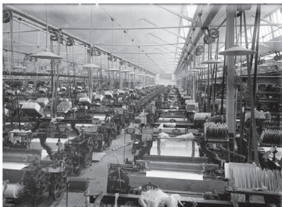
Widok hali tkalni w latach międzywojennych. Pod sufitem ułożone są wały transmisyjne, z których napęd krosien odbywa się pasami płaskimi (Fot. Alojzy Stuglik, zdjęcie ze zbiorów APB-B)
