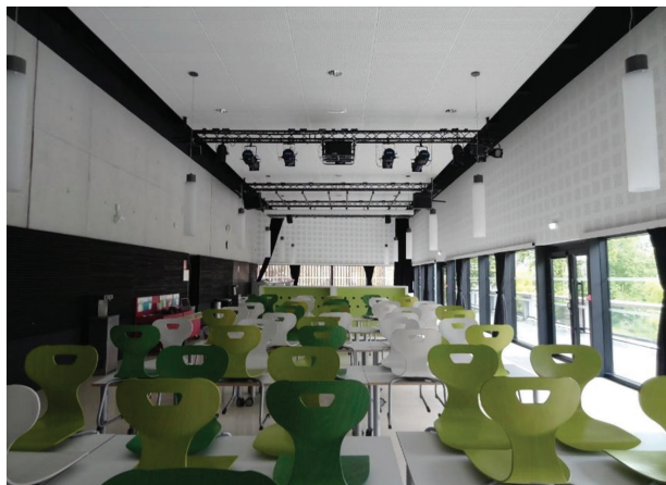
Il. 4. Szkoła Pôle Molière, ekoosiedle Mureaux (proj. AKLA Architectes). Salę wyposażono w mosty i sztankiety przydatne do inscenizacji teatralnych (fot. M. Trojanowska)
