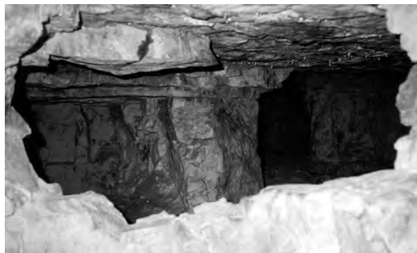
4. Metoda scalania górotworu za pomocą żywicy okazała się niestety pomyłką
