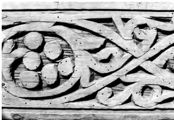
3. Stare otwory wylotowe bliżej nieokreślonego gatunku z rodziny kołatkowatych ( Anobiidae ) na powierzchni elementu koptyjskiej snyderki, znajdującym się w jednej z licznych kolekcji muzealnych Kairu
