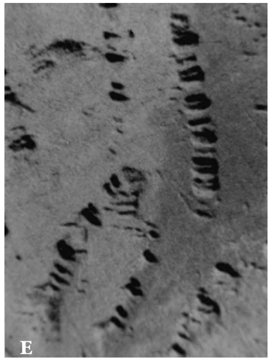
8. Poszczególne fazy oszpecania (A, B, C) i niszczenia (D, E) piaskowca w monumentalnych budowlach z czasów faraonów w Górnym Egipcie, spowodowane przez obrostkę Chalicodoma siculum (Risso). A — opuszczone gniazdo z widocznymi otworami wylotowymi (sklepienie „sali na barkę” świątyni królowej Hatszepsut w Deir el-Bahari), B — uszkodzone gniazdo z widocznymi komorami larw (również świątynia królowej Hatszepsut), C — świeże ślady po usuniętym gnieździe (jak wyżej), D — stosunkowo świeży „wżer” w kamieniu (świątynia w Luksorze), E — stare „wżery” w kamieniu (świątynia w Luksorze)
