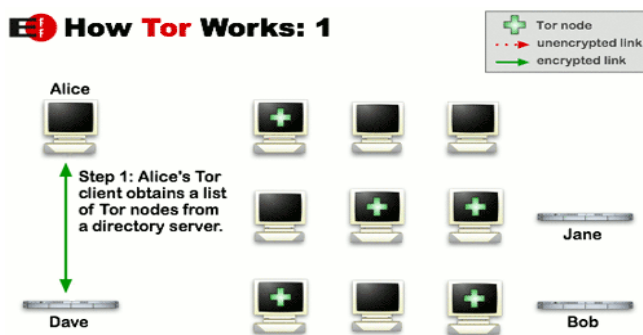
Rys. 2. Petent pobiera szyfrowanym połączeniem listę węzłów TOR-a z serwera katalogowego
