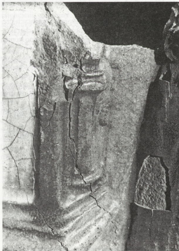
3. Fragment kafla portretowego — spękania i odspojenia szkliw wynikające m.in. z niszczącej działalności soli mineralnych. Fot. M. Rudy
