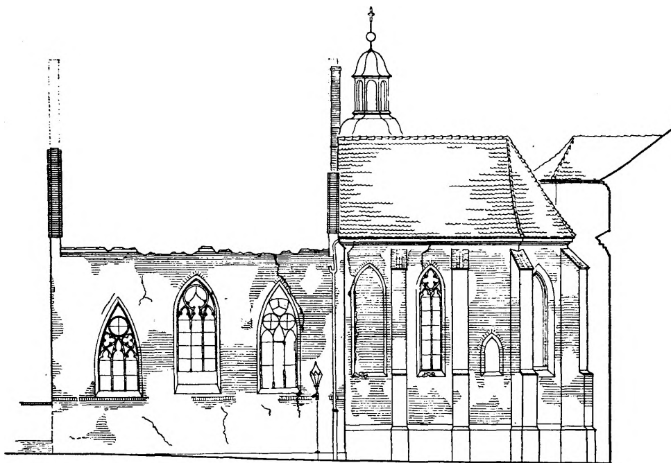
Ryc. 248. Elewacja południowa — inwentaryzacja stanu zniszczeń (skala ok. 1:250).
