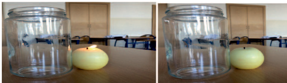
Zdjęcia 8 i 9. Eksperyment przesłon owalnych zginających strumień powietrza i prowadzących do zgaszenia świecy
