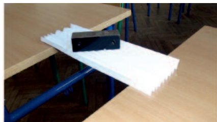
Zdjęcia 6 i 7. Konstrukcje papierowe o wytrzymałości 1 kg (niepoprawne i poprawne) Źródło: badania własne.
