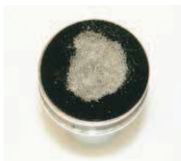
Zdj. 1. Stolik mikroskopowy z próbką mieszaniny pirotechnicznej przyklejonej za pomocą węglowego plasterka przewodzącego.
