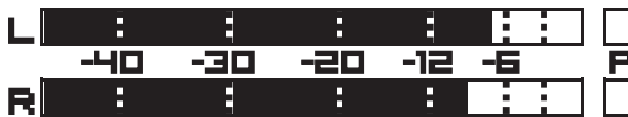
OBRÁZEK 3: Stupnice dBFS na displeji přístroje. Černá výplň ukazuje přibližné hodnoty pro levý a pravý mikrofon (-7 dBFS, resp. -9 dBFS). Oddělené pole P („Peak“) by indikovalo překročení maxima.
