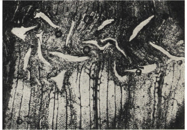
Ryc. 12. Mikroskopowy obraz drewna dębowego, przekrój poprzeczny: a) drewno normalne, b) drewno sprasowane wewnątrz w kierunku promieniowym i stycznym. Wg Kordeckiego
