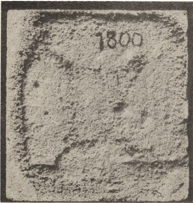
2. Płytkę wyciętą z próbki wzmocnionego napięcia, po wytrawieniu w czasie 15 minut w HCl; widoczne zagęszczenia substancji wzmacniającej w próbce (wymiary próbki 5×5 cm)
