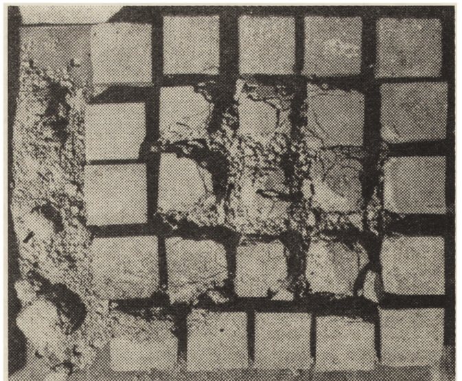
11. Zniszczenie próbek wzmocnionych (z dużego bloku) i kontrolnych: a — po 80 cyklach zamrażania; b — po 100 cyklach zamrażania (wymiary próbek 5 \times 5 \times 5 cm)
