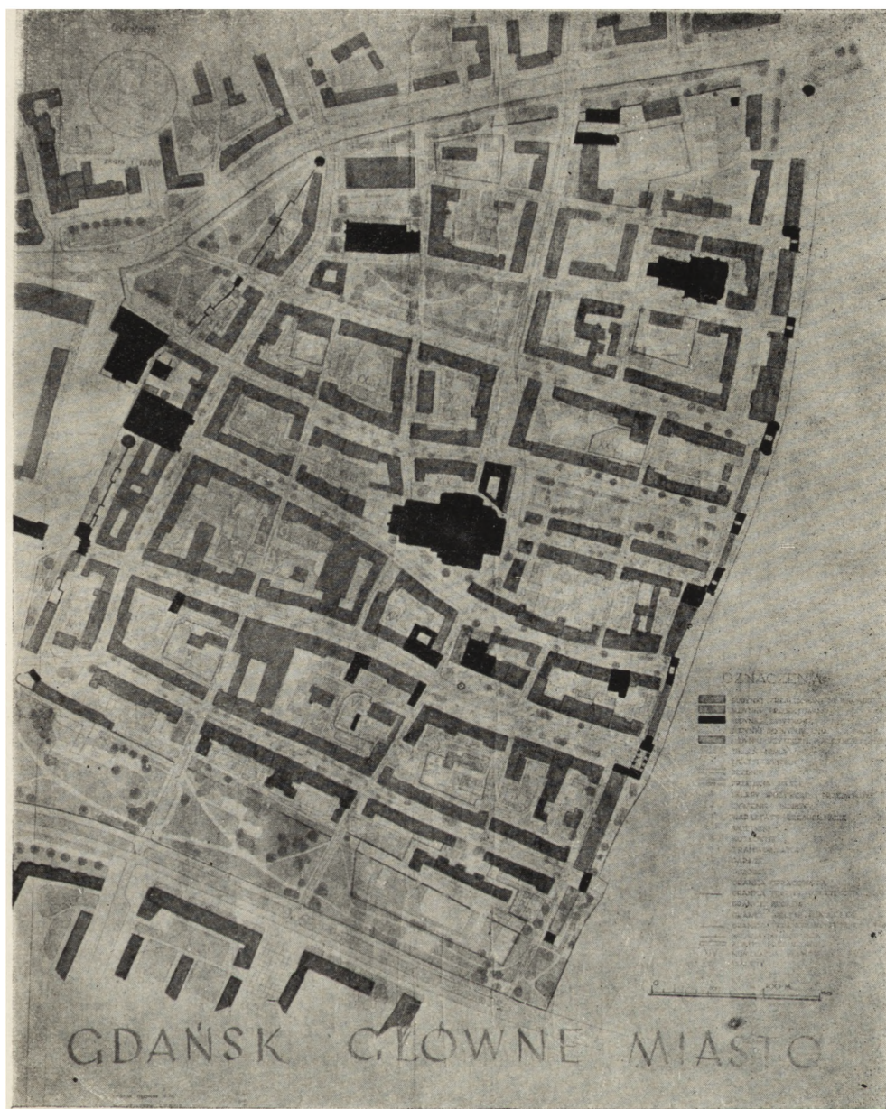
Ryc. 91. Gdańsk — Miasto Główne. Rzut całości układu w ostatecznej wersji: zrezygnowano z zabudowy południowej strony ul. św. Ducha, przesunięto zachodnią pierzeję ul. Groble, blok między ul. Szeroką, Świętojańską i Groble pozostaje niezabudowany jako rezerwa. Odbudowa zachodniej ściany ul. Groble 1 będzie tematem konkursu. Ostatnio przyjęto zabudowę pobrzeża Motławy do ul. Straganiarskiej. Powierzchnia całości Głównego Miasta — 40 ha, ilość mieszkańców w perspektywie — 11.500. Opracowanie Miastoprojekt-Gdańsk. Autorzy ostatecznej wersji projektu urbanistycznego. R. Hordyński i Z. Żuławski (poprzednich opracowań K. Lisowski i W. Gruszkowski). Gen. projektant L. Kadłubowski.
