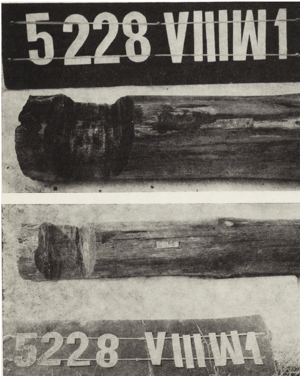
4. 5. Fragment okrągłaka W 1 pochodzącego z chalupy 5228 VIII – przed konserwacją (4) i po roku od chwili przeprowadzenia konserwacji (5) (fot. A. Chrzanowski)
