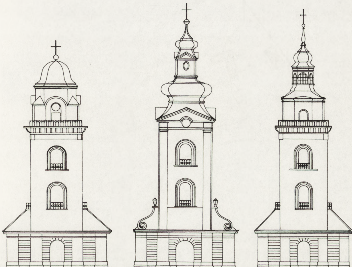
6. Dzwonnica przy kolegiacie: A — stan po przebudowie w 1828 r., B — rekonstrukcja stanu z XVIII w., C — projekt nowego helmu, opr. arch. E. Kranz, 1929 (wg S. Misieczko-Rudnik)
