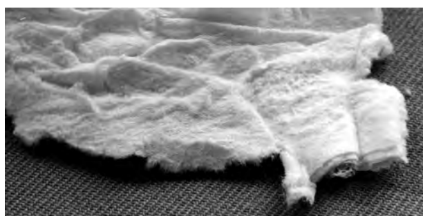
14. Fragment pelike w trakcie ekstrakcji zemulgowanych i zmydlnych substancji oleistych. U dołu: fragment okładu przesycony brunatnym osadem mydeł rozpuszczalnych w wodzie
