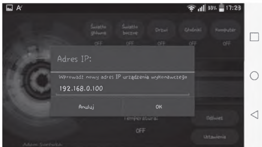
Rys. 8 Wprowadzanie adresu IP urządzenia wykonawczego
