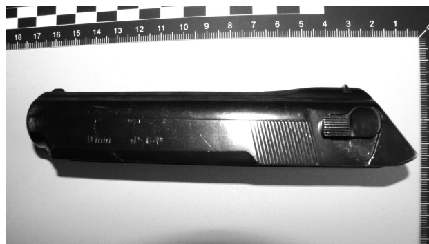
Ryc. 3. Zamek pistoletu P-64 (bezpiecznik w położeniu „ODBEZPIECZONY”).
