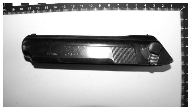
Ryc. 2. Zamek pistoletu P-64 (bezpiecznik w położeniu „ZABEZPIECZONY”).
