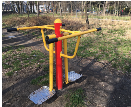
Ryc. 15. Urządzenie „Narciarz /wahadło” Funkcją tego urządzenia jest wzmocnienie siły rąk, nóg, pasa biodrowego, poprawa ruchomości stawów i polepszenie ogólnej kondycji Fot. A. Pawlikowska-Piechotka, 2020
