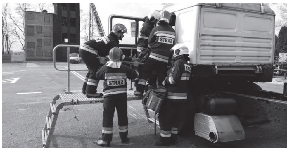
Fot. 6. Podest ewakuacyjny – ustawienie bokiem krótkim do drzwi, bariereka zabezpieczająca ustawiona w kierunku przodu pojazdu
