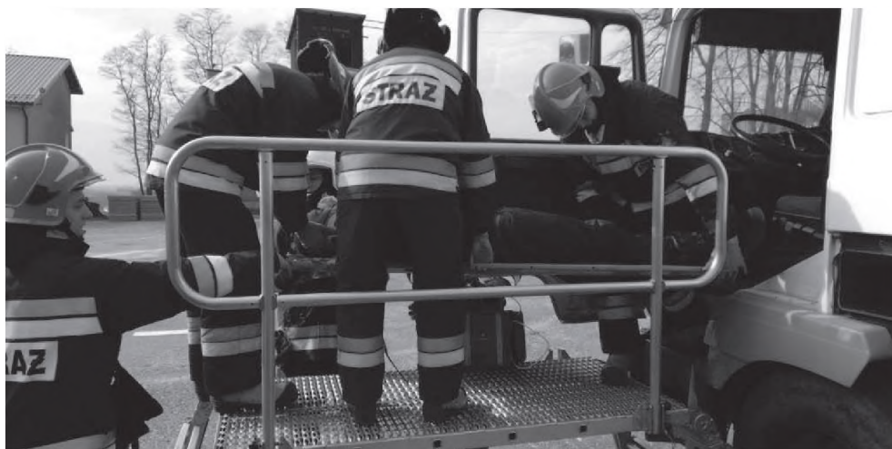
Fot. 5c. Podest ewakuacyjny – ustawienie bokiem krótkim do drzwi, bariereka zabezpieczająca ustawiona w kierunku tyłu pojazdu, dalszy etap ewakuacji
