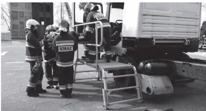
Fot. 4b. Podest ewakuacyjny – ustawienie bokiem długim do drzwi, dalszy etap ewakuacji
