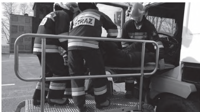
Fot. 5b. Podest ewakuacyjny – ustawienie bokiem krótkim do drzwi, barierka zabezpieczająca ustawiona w kierunku tyłu pojazdu, dalszy etap ewakuacji
