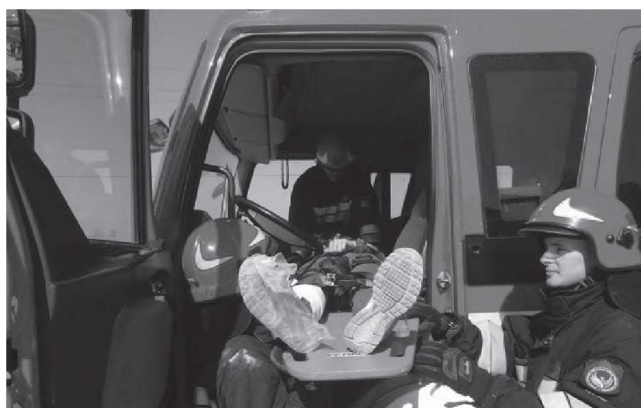
Fot. 8a. Ewakuacja poszkodowanego na desce ortopedycznej bez użycia podestu ewakuacyjnego przez drzwi od strony kierowcy
