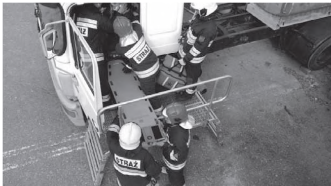
Fot. 4c. Podest ewakuacyjny – ustawienie bokiem długim do drzwi, dalszy etap ewakuacji, widok z góry
