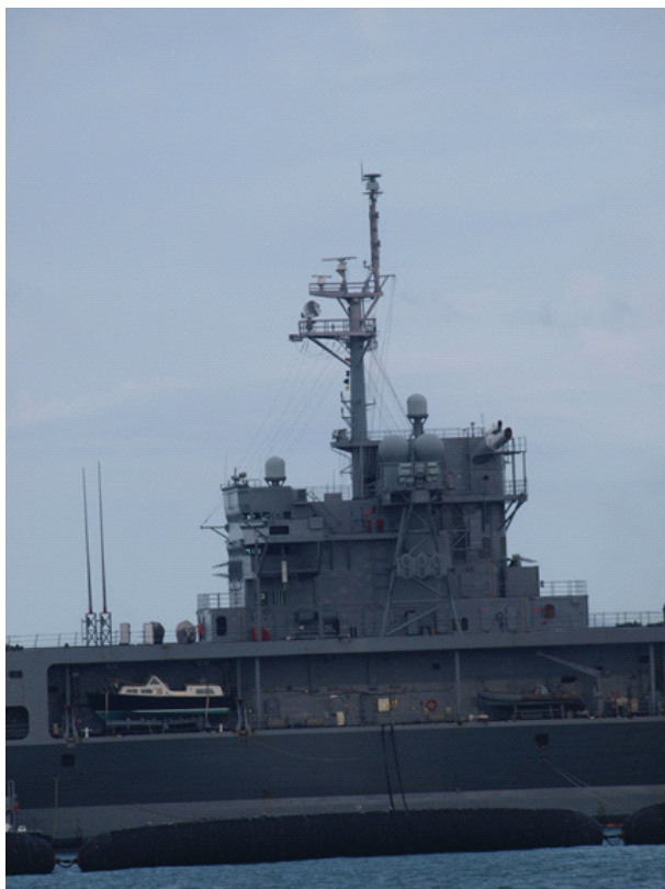
Widok na centralną nadbudówkę USS „Mont Whitney”, widać rozbudowane systemy łączności, niezbędne na jednostce dowodzenia, fot. M. Franz
