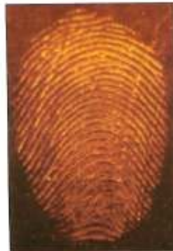
Ryc. 25. Dwutygodniowy ślad linii papilarnych skonstrastowany safraniną O po pierwszym przyłożeniu na klejącej stronie taśmy biurowej Fig. 25. Two-week old fingerprint visualized using Safranin O after first application on the sticky side of office tape
