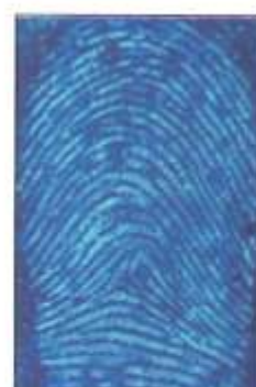
Ryc. 17. Miesięczny ślad linii papilarnych po pierwszym przyłożeniu skonstrastowany Basic Yellow 40 na nieklejącej stronie taśmy izolacyjnej
