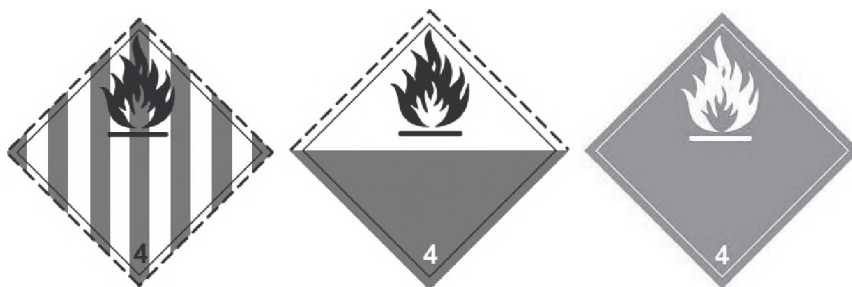
Rys. 4. Oznaczenie klasy 4 – Łatwopalne ciała stałe; substancje podatne na samozapłon; substancje, które w kontakcie z wodą wydzielają łatwopalne gazy
