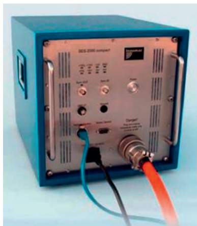
Ryc. 5. Profilomierz osadów (Subbottom profiler) SES-2000. A: jednostka centralna; B: przetwornik z kablem; fot. Instytut Morski w Gdańsku
