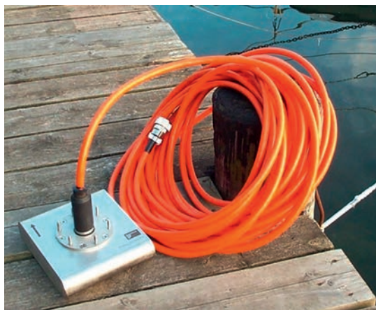
Ryc. 5. Profilomierz osadów (Subbottom profiler) SES-2000. A: jednostka centralna; B: przetwornik z kablem; fot. Instytut Morski w Gdańsku
