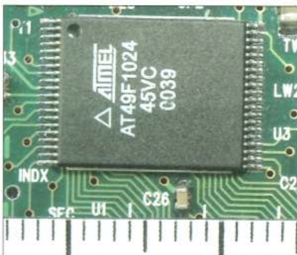
Ryc. 4. Przykład układu w obudowie TSOP Fig. 4. Example of integrated circuit on box type TSOP
