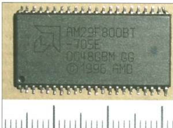
Ryc. 2. Wygląd układów w obudowie typu SOP i SO Fig. 2. View of integrated circuit on box type SOP and SO
