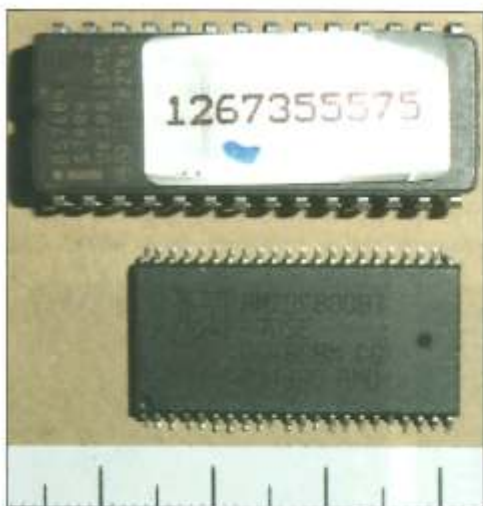
Ryc. 3. Różnice w wyglądzie układów w obudowie typu DIP i SOP Fig. 3. View of integrated circuit on box DIP and SOP – differences
