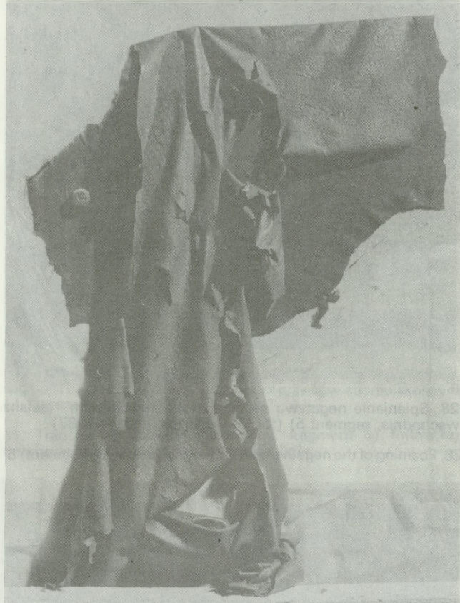
27. Usuwanie kauczuku z licowania po spienieniu negatywu (fot. J. Doraczek, luty 1987)
