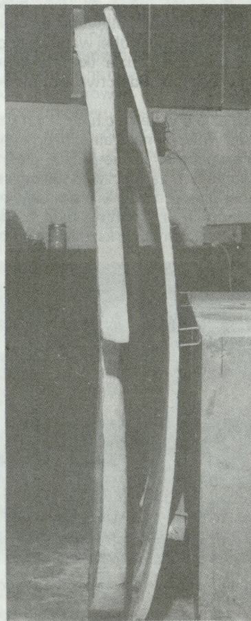
5. Rozprostowane podłoża ze spienionego poliuretanu ( Błogosławieństwo Tobiasza ) w porównaniu z podłożem przekładkowym utrzymującym krzywiznę ( Niewierny Tomasz ). Oba malowidła z mauzoleum Panwitzów w Udaniu. (fot. J. Doraczek, 1987)
