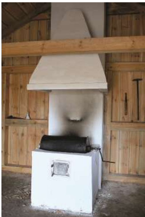
Ryc. 4. Urządzenia technologiczne olejarni po renowacji i translokacji do „Łęczyckiej Zagrody Chłopskiej” w Kwiatkówku pod Łęczycą. Urządzenia paleniskowo-dymne z kociołkiem do podgrzewania śruty. (fot. P. Czepas)
