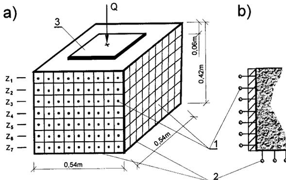
Fig. 3. Basic parameters of the test bench [Surowiecki 1988; Mazur, Surowiecki 1989; Surowiecki 1989]:
