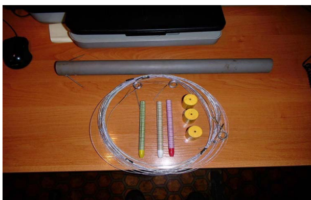
Rys. 9. Trójpoziomowy rozwarstwieniomierz linkowy (Duży i in. 2017a)
