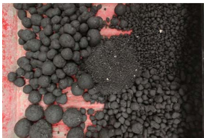
Rys. 6. Muły węglowe (PG SILESIA) i CaO (próbka 7). Fot. J. Feliks
