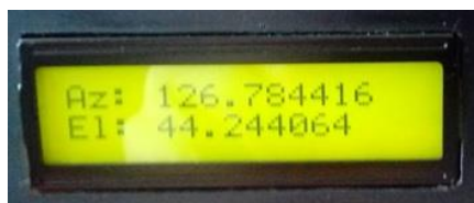
Rys. 6. Obliczone przez sterownik współrzędne horyzontalne; Az – azymut, El – wysokość Źródło: opracowanie własne.
