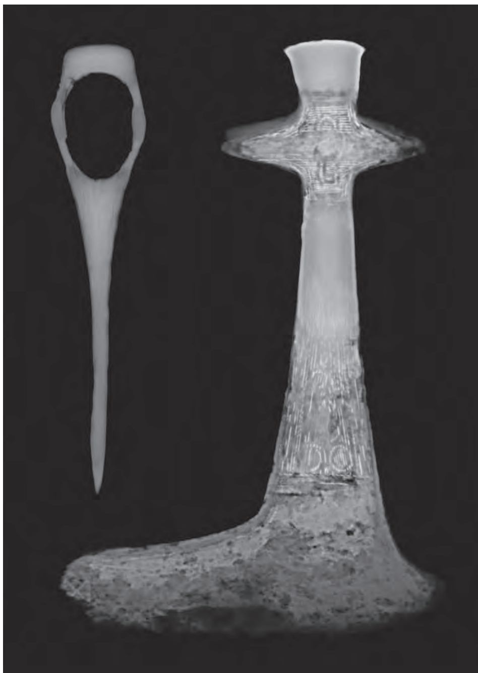
Ryc. 8. Rentgenogram żelźca czekana wydobytego z reliktyw mostu wiodącego na wyspę Ledniczkę na jeziorze Lednica. Od lewej: rzut z góry, prawe lico. Fot. S. Magnowski, oprac. P. Kucypera
