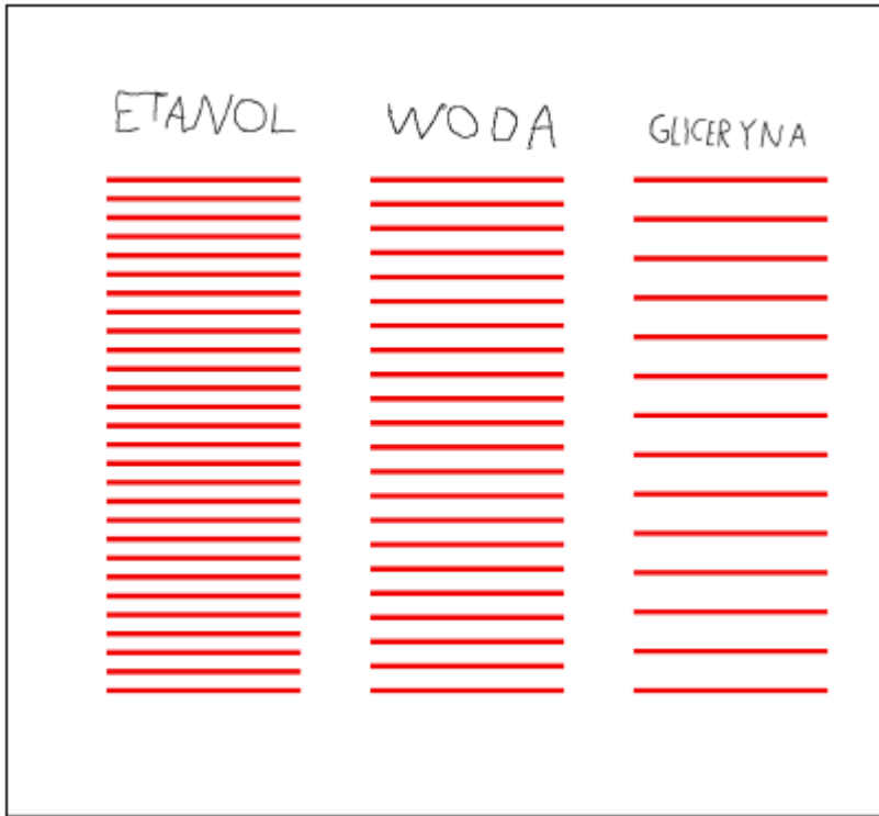
Rysunek 7. Przykład uzyskanego na kartce porównania długości fali w cieczach.
