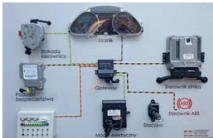
Ryc. 6. Symulator sieci informatycznych dla pojazdu Audi A6 (PW SiMR).
