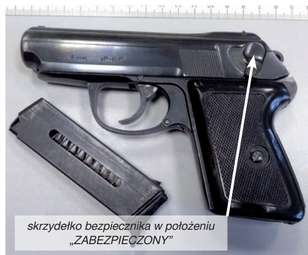
Ryc. 4. Widok lewej strony pistoletu P-64 z odłączonym magazynkiem naboju.
