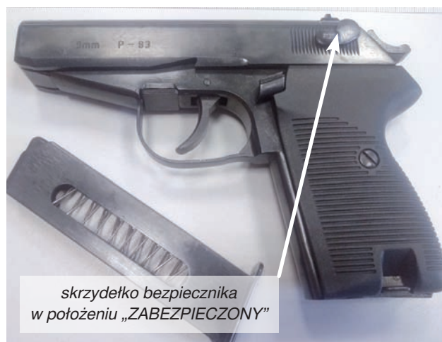
Ryc. 1. Widok lewej strony pistoletu P-83 z odłączonym magazynkiem naboju.
