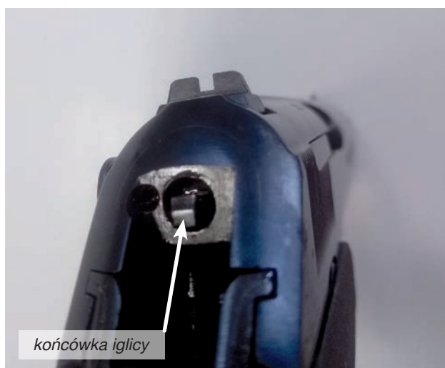
Ryc. 3. Położenie końcówki iglicy pistoletu przy bezpieczniku w położeniu „ZABEZPIECZONY”.
