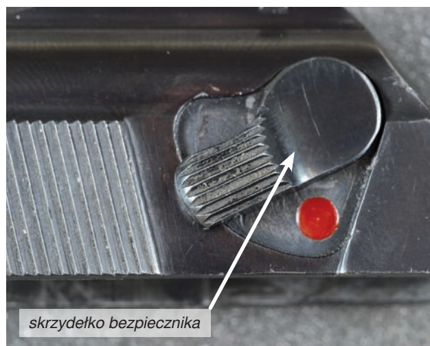
Ryc. 5. Widok skrzydełka bezpiecznika pistoletu P-64 z iglicą obróconą o kąt 90^\circ .
