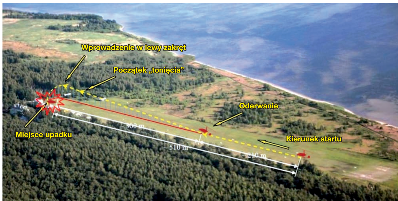
Ryc. 2. Widok i szkic sytuacyjny miejsca zdarzenia (wypadek wiatrakowca podczas startu).
