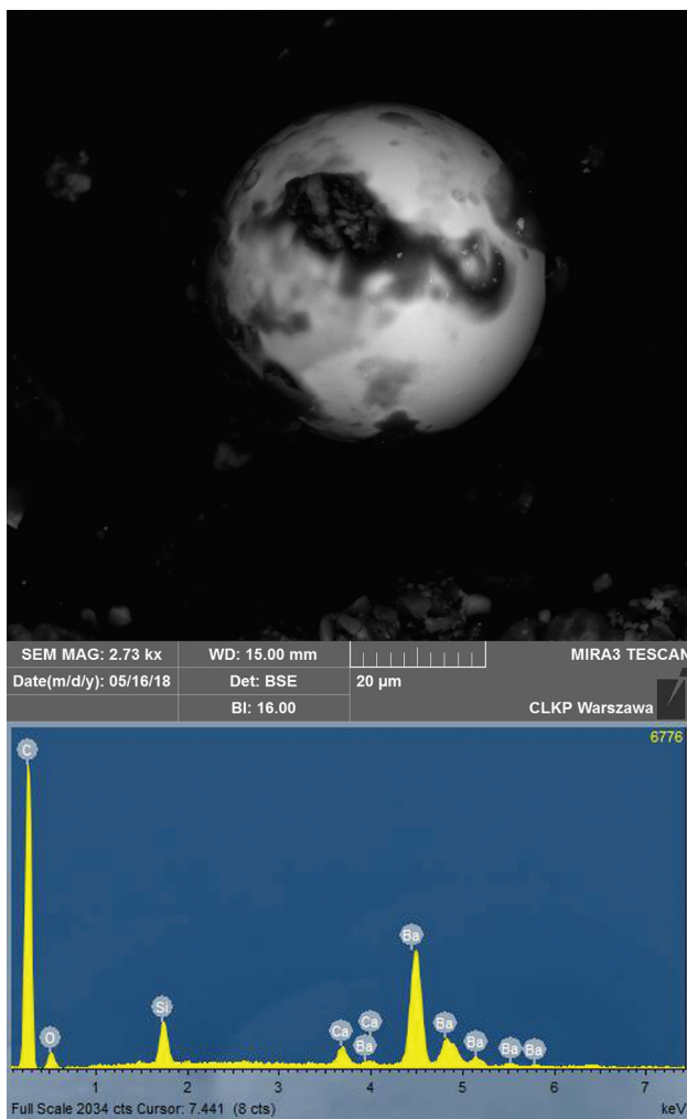
Ryc. 7. Obraz oraz widmo EDX cząstki BaCaSi ujawnionej na kanapie oznaczonej kodem K17.
