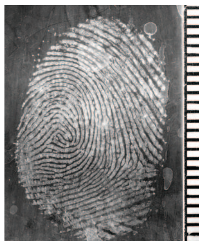
Ryc. 95. Trzymiesięczny ślad linii papilarnych ujawniony Wet Powder White na powierzchni woreczka do mrożenia.
