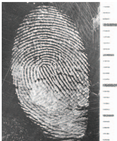
Ryc. 91. Dwumiesięczny ślad linii papilarnych ujawniony Wet Powder White na powierzchni woreczka śniadaniowego.
