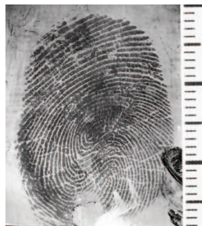
Ryc. 20. Dwumiesięczny ślad linii papilarnych po zastosowaniu Wet Powder White na powierzchni woreczka śniadaniowego.
